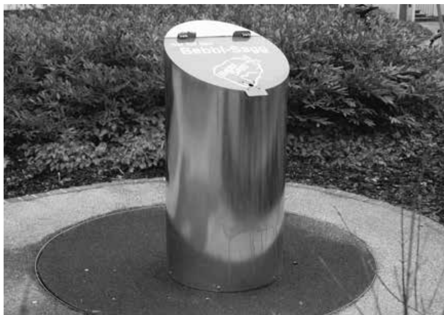
Unterflurcontainer werden in Basel schon seit geraumer Zeit beispielsweise auf dem Erlenmatt-Areal angewendet. Foto: Harald Friedl
